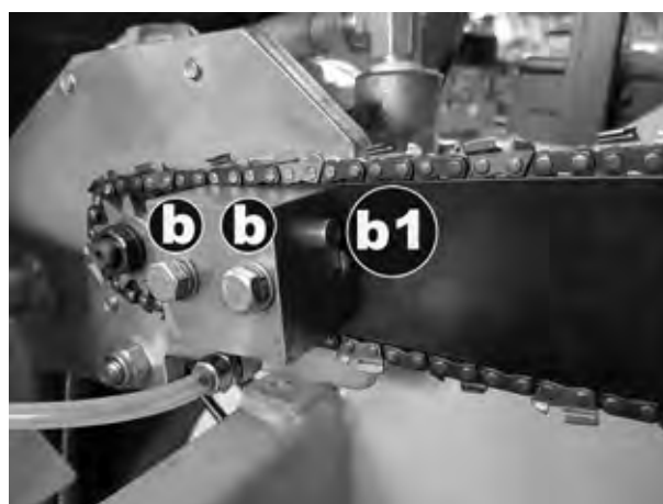
(b1) Kedjespänningsjusteringsskruv (b) Kedjespänningsfixeringsskruv
