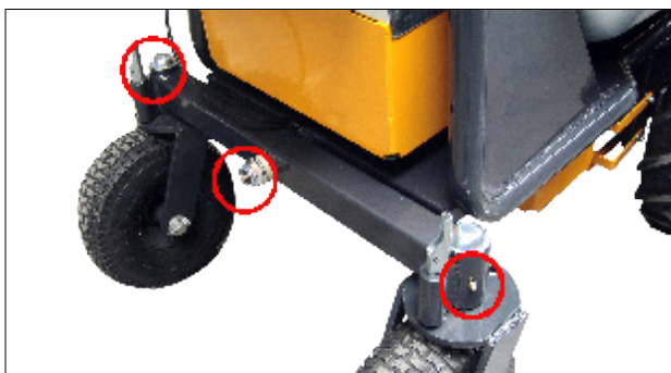
Smörj om pivotpunkterna på pendelaxeln var 20:e drifttimme.
