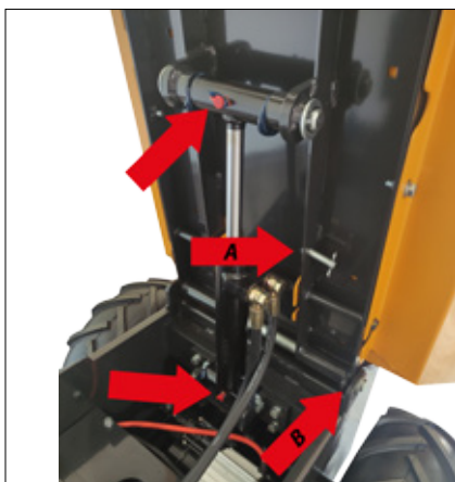
Smörj om smörjpunkterna på hydraulcylindern var 20:e drifttimme.
