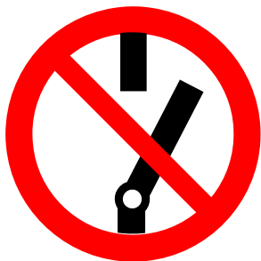
Bild 7: Exempel på en varningsskylt för att säkra att den slås på igen
